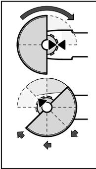
Setzen Sie die Schutzhaube **11** der Abbildung entsprechend auf den Spindelhalbs. Die Dreiecksmarkierungen der Schutzhaube müssen mit den entsprechenden Markierungen am Getriebekopf übereinstimmen.
