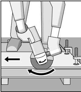
Das Elektrowerkzeug muss stets im Gegenlauf geführt werden. Es besteht sonst die Gefahr, dass es **unkontrolliert** aus dem Schnitt gedrückt wird.
