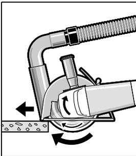
Schalten Sie das Elektrowerkzeug ein und setzen Sie es mit dem vorderen Teil des Führungsschlittens auf das Werkstück. Schieben Sie das Elektrowerkzeug mit mäßigem, dem zu bearbeitenden Material angepasstem Vorschub. Beim Trennen besonders harter Werkstoffe, z. B. Beton mit hohem Kieselgehalt, kann die
