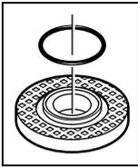
Im Aufnahmeflansch **7** ist um den Zentrierbund ein Kunststoffteil (O-Ring) eingesetzt. **Fehlt der O-Ring oder ist er beschädigt**, muss der Aufnahmeflansch **7** vor der Weiterverwendung unbedingt ersetzt werden.
