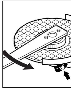
Eine ordnungsgemäß befestigte, unbeschädigte Schnellspannmutter können Sie durch Drehen des Rändelringes entgegen dem Uhrzeigersinn von Hand lösen. **Lösen Sie eine festsitzende Schnellspannmutter nie mit einer Zange, sondern verwenden Sie den Zweilochschlüssel.** Setzen Sie den Zweilochschlüssel wie im Bild gezeigt an.
