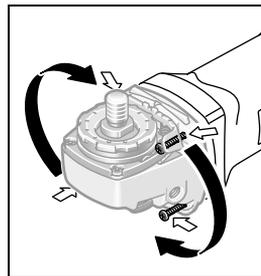
Sie können den Getriebekopf in  $90^\circ$ -Schritten drehen. Dadurch kann der Ein-/Ausschalter für besondere Arbeitsfälle in eine günstigere Handhabungsposition gebracht werden, z. B. für Trennarbeiten mit der Absaughaube mit Führungsschlitten **20** oder für Linkshänder.
